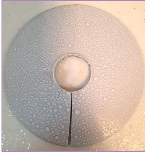
شکل (۸): انجام آزمون آگریزی به روش افشانه ۱۲ ساعت بعد از تمیز کردن سمت راست نمونه با دستمال خشک.
