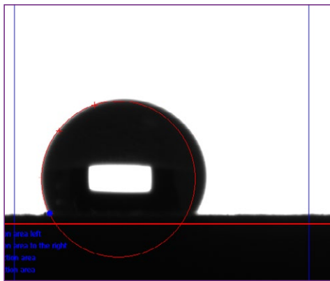
شکل (۱۰): اندازه‌گیری زاویه تماس استاتیک قطره آب روی نمونه بعد از آزمون انتقال آبگریزی.
