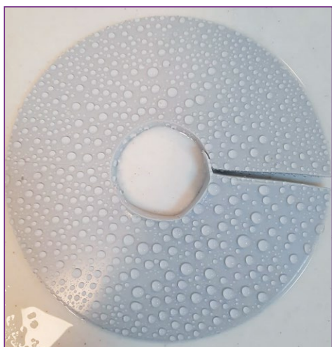
شکل (۵): انجام آزمون آبریزی به روش اسپری کردن بدون تمیز کردن نمونه.
