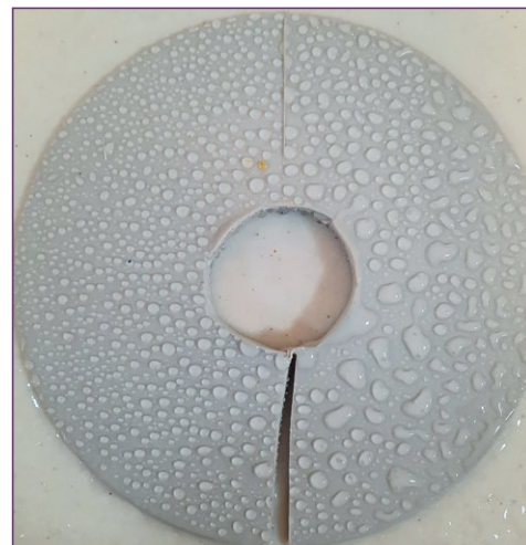
شکل (۷): انجام آزمون آگریزی به روش افشانه یک ساعت بعد از تمیز کردن سمت راست نمونه با دستمال خشک.
