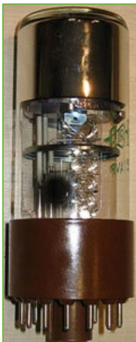
شکل (۵): لوله تشدید کننده نوری (PMT) [۱۶].
