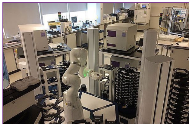
شکل (۲): دستگاه میکروپلیت ریدر یکپارچه شده با ایستگاه کاری رباتیک مدولار با قدرت تفکیک بالا در آزمایشگاه تحقیقاتی آستارازنیکا انگلستان [۳].
