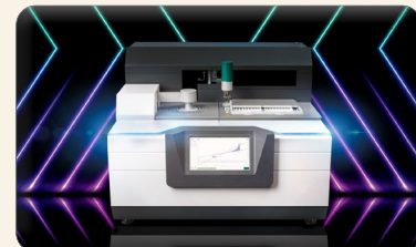
تعیین خلوص مواد با استفاده از دستگاه گرماسنج روبشی تفاضلی (DSC)
