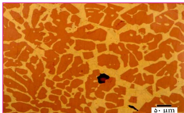
شکل (۱): ریزساختار آلیاژ ریختگی طلا-۲۲ درصد آلومینیوم [۱].
