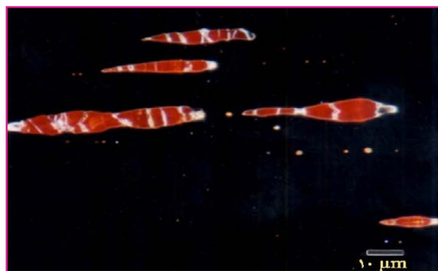
شکل (۲): ریزساختار اکسید مس قرمز رنگ در مس آرسنیک‌دار در زمینه تاریک [۱].
