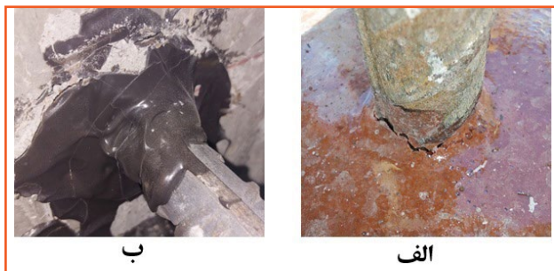
شکل (۴): نمایی از ترک سطحی ایجاد شده در (الف): اپوکسی-اکریلات و (ب): رزین اپوکسی.
