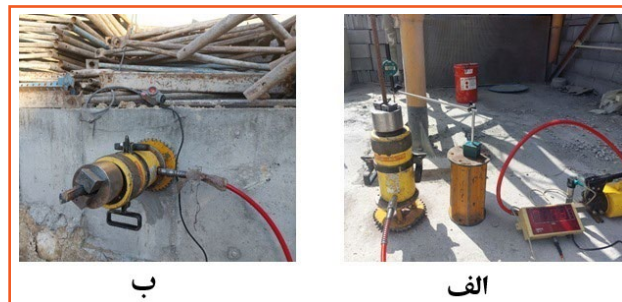
شکل (۱): نمایی از آزمایش بیرون کشی آرماتور در محل با استفاده از سیستم هیدرولیک. (الف): کاشت عمودی و (ب): کاشت افقی.
