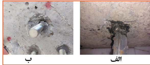
شکل (۵): نمایشی از ترک و گسیختگی گوه‌ای شکل در سطح بتن.
