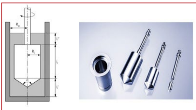
شکل (۹): سیستم اندازه‌گیری استوانه‌های هم محور موازی [۷].
