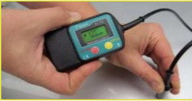
شکل (۱۹): چگونگی انجام آزمون ضخامت‌سنجی رنگ به روش فراصوت [۲۰].
