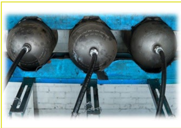
شکل (۲): نمایی از دستگاه آزمون چرخه فشار مخازن [۲].
