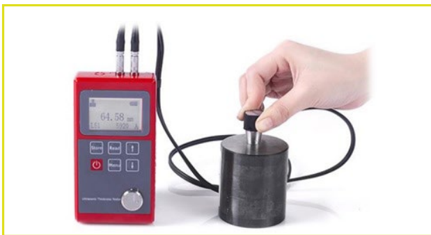
شکل (۱۱): نمایی از دستگاه و چگونگی آزمون ضخامت‌سنجی به روش فراصوت [۱۲].
