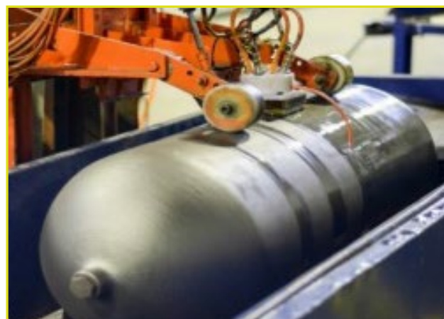
شکل (۱۰): نمایی از دستگاه آزمون ترک‌یابی مخازن به روش فراصوت [۲].
