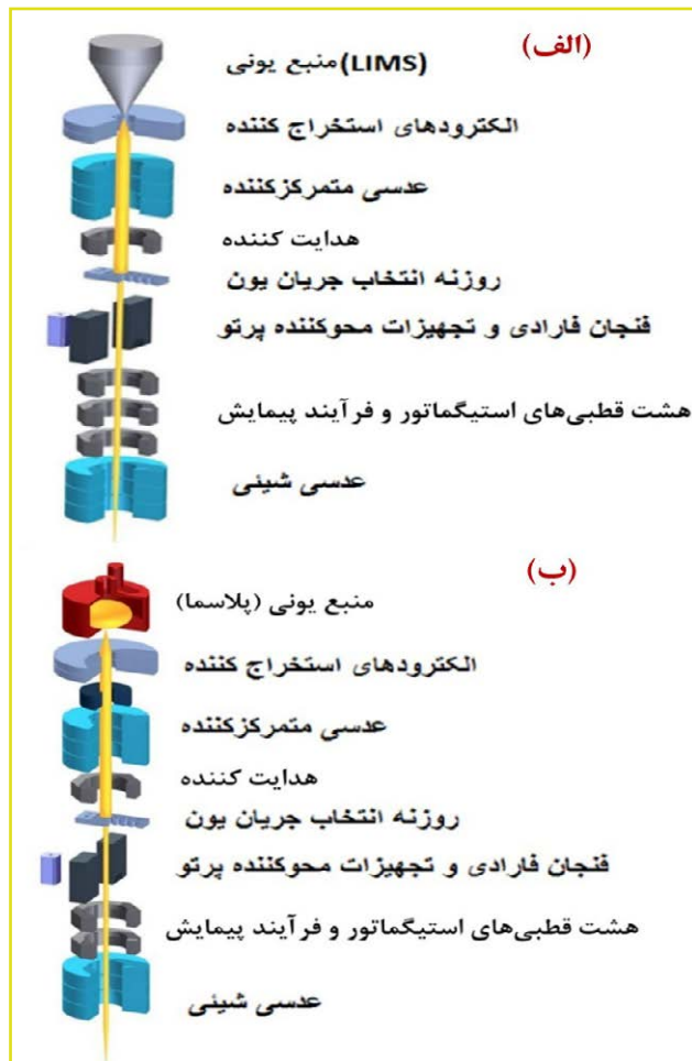
شکل (۲): نمایی از ستون FIB. (الف): ستون FIB دربرگیرنده منبع یونی (LIMS) و (ب): ستون FIB دربرگیرنده منبع یونی پلازما [۳].
