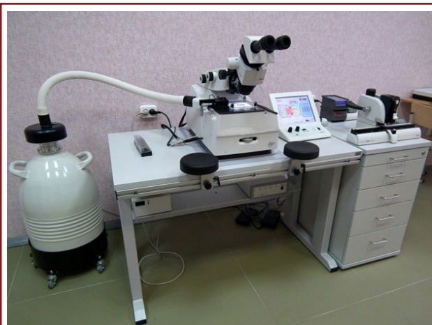
شکل ۵: نمونه‌ای از دستگاه کرایو-اولترامیکروتوم همراه مخزن نیتروژن مایع (سمت چپ تصویر) و دستگاه GLASS KNIFE MAKER ۲۱ (سمت راست تصویر) [۳].
