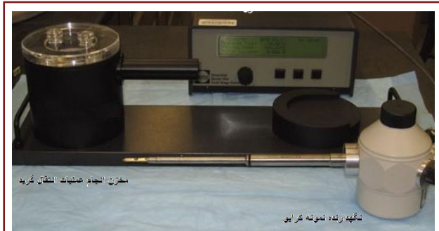
شکل ۱۳: تجهیزات جانبی مورد نیاز برای آماده‌سازی Cryo-Specimen Holder به منظور قرار گرفتن درون میکروسکوپ Cryo-TEM [۴].
