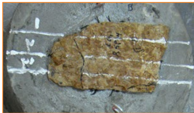
شکل (۷): اندازه‌گیری سه مقدار JRC در راستای برش برای یک نمونه بزرگ مقیاس.
