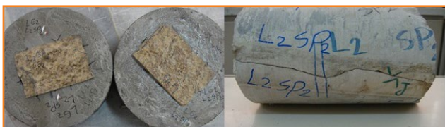
شکل (۶): مغزه سنگ دارای درزه طبیعی با قطر ۱۵ سانتی‌متر (سمت راست)، درزه طبیعی پس از قالب‌گیری و آماده‌سازی برای انجام آزمایش برش مستقیم (سمت چپ).
