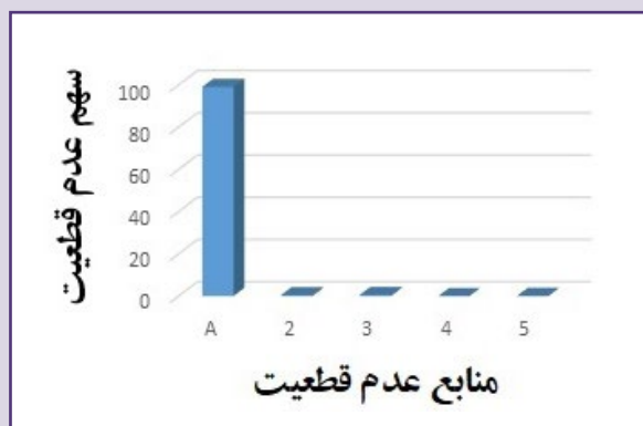
شکل (۱): مقایسه سهم منابع مختلف در عدم قطعیت کل دستگاه اندازه‌گیری دمای نرمی ویکات
