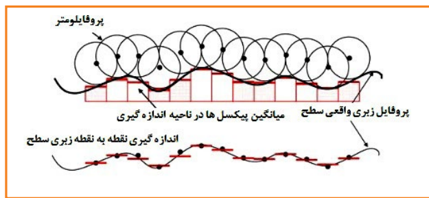
شکل (۱۹): مقایسه روبش پروفایلمتری و تداخل‌سنجی در امتداد خط روبش سطح [۱۹].
