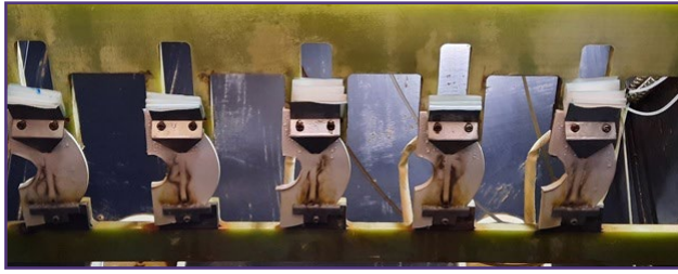
شکل (۴): چگونگی بستن نمونه‌ها در آزمون ترکینگ سطح شیبدار.
