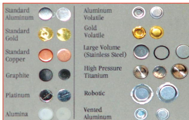
تصویر ۲: ظروف آزمون گرماسنجی روبشی تفاضلی [۲].
