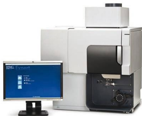
شکل ۸: طیفسنج پلاسمای جفت شده القائی - نشر نوری [۸].
